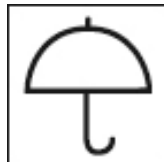
Beskyttes mot fuktighet
